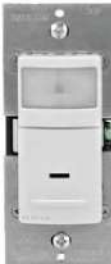
Sensor Universal Encendido automático 120V~ 60Hz 180° PIR 150W LED / CFL 300W Incandescente 1/6 hp 2.5A 1 Polo Encendido relay Requiere tierra Cat. IPS02
